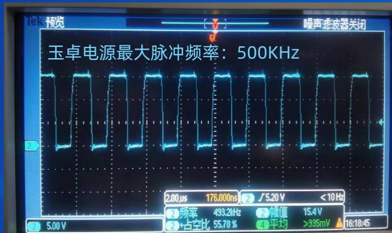
玉卓光电激光驱动：脉冲波形
